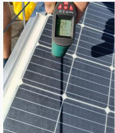
Afbeelding 4: Temperatuurmeting van een deel van een PV-cel in de zon, met een infraroodlaserthermometer
