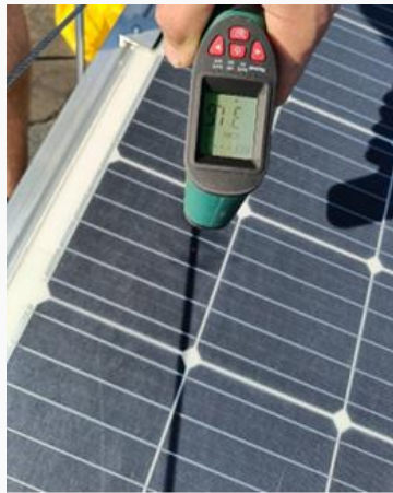
Afbeelding 3: Temperatuurmeting van een deel van een PV-cel in de schaduw, met infrarood laserthermometer
